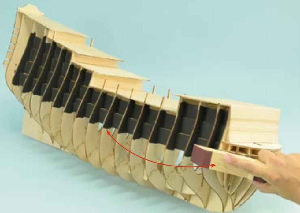
**1** С этого выпуска мы приступаем к обшивке каркаса корпуса — тонкой и трудоемкой работе, требующей внимания и усидчивости. Для начала возьмите шлифовальный блок с наждачной бумагой достаточно крупной зернистости и обработайте им кромки шпангоутов и носовых деталей (то есть снимите малку), чтобы приклеиваемые планки лучше прилегали к шпангоутам. При этом уделите особое внимание носовой и кормовой частям: планки должны полностью прилегать к кромкам шпангоутов, не образуя выпуклостей или впадин.
