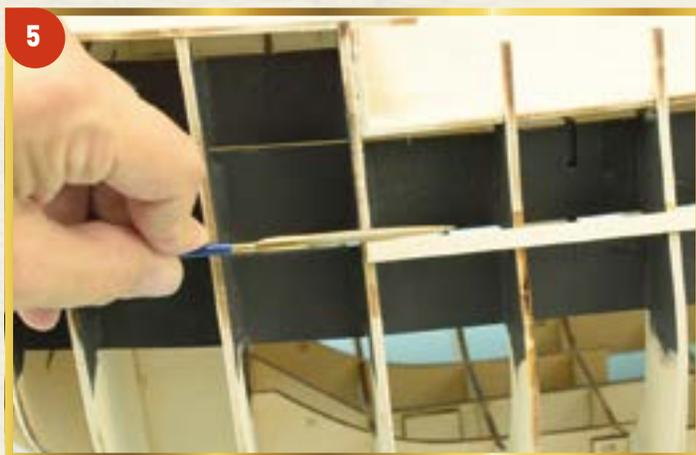
**5** С помощью надфиля удалите следы клея возле концов планки, сделав кромки шпангоутов чистыми и готовыми к установке следующих планок.
