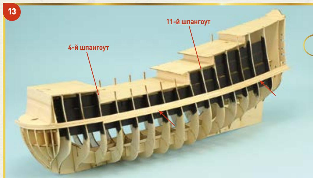
**13** Обрежьте до необходимой длины и наклейте на шпангоуты — с четвертого по одиннадцатый — новую планку, а следующую — на заднюю часть каркаса, начиная с одиннадцатого шпангоута.
