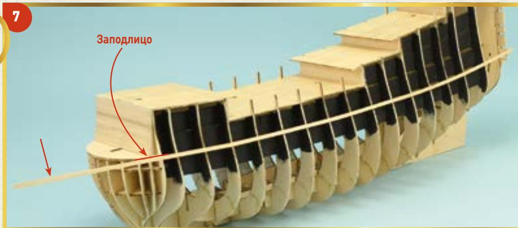
**7** Приклейте третью планку к передним шпангоутам модели, завершая таким образом первый пояс обшивки. Верхний край этой планки должен лежать на одном уровне с поверхностью носовой палубы.
