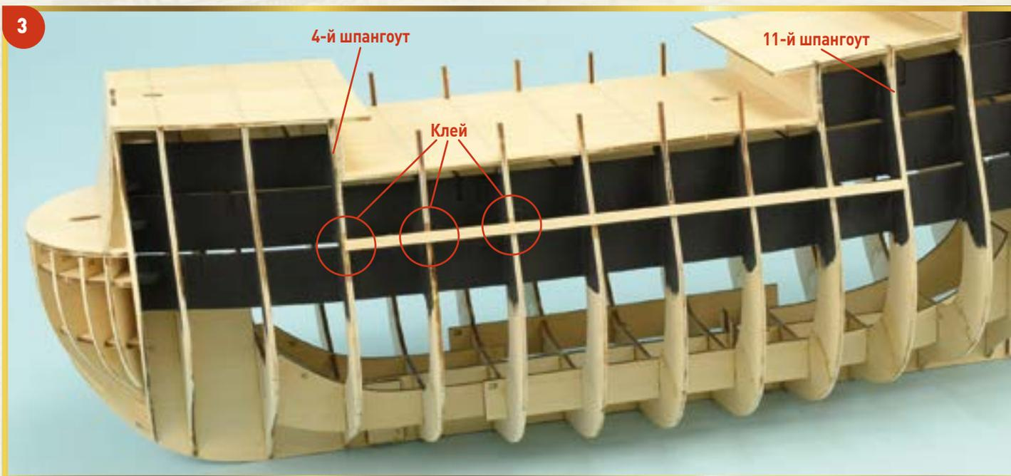
**3** Обрежьте планку 1,5 x 5 x 300 мм таким образом, чтобы ее концы находились ровно посередине кромок четвертого и одиннадцатого шпангоутов. Затем приклейте данную планку к четвертому, пятому и шестому шпангоутам под двумя карандашными отметками, сделанными вами в предыдущем шаге.
